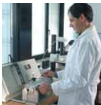
Instrument électronique permettant d'identifier la composition chimique de la matière première
