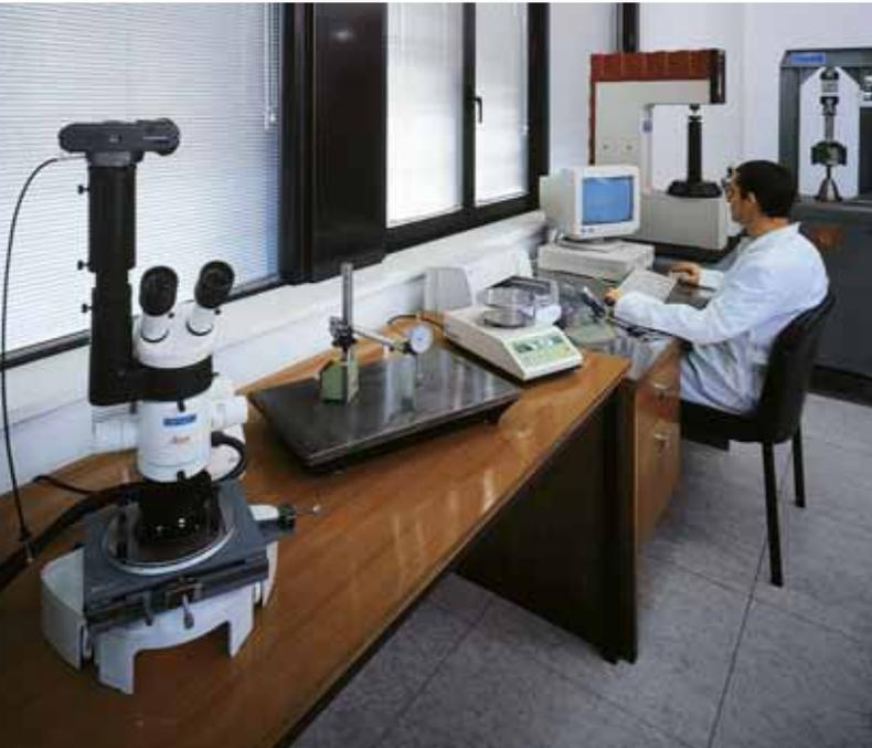
*Au premier plan : microscope stéréoscopique grand-angulaire avec tube photo électronique pour macrographies.*
